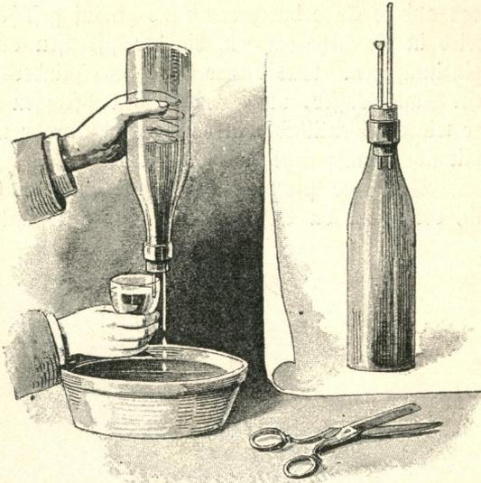
so daß der kurze Strohhalm bis an den Boden des Glases reicht; mit einer Schere schneidest du das verschlossene Ende ab, und das Wasser fängt an aus der langen Röhre herauszulaufen, bis das Glas leer geworden, während die Flasche wie vorher noch immer voll ist.
