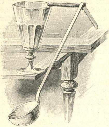
fels wird so zusammengeklemt, damit der Löffel nicht ausgleiten kann und daß er (in senkrechter Richtung) mit dem Schaft des Messers einen Winkel von ungefähr 45 Grad bildet. Das Ganze kommt in Gleichgewicht, wenn du das Ende des Messerschaftes auf einer Tischkante, auf einer Fingerspitze oder auf dem Rand eines mit Wasser gefüllten Glases anbringst.
